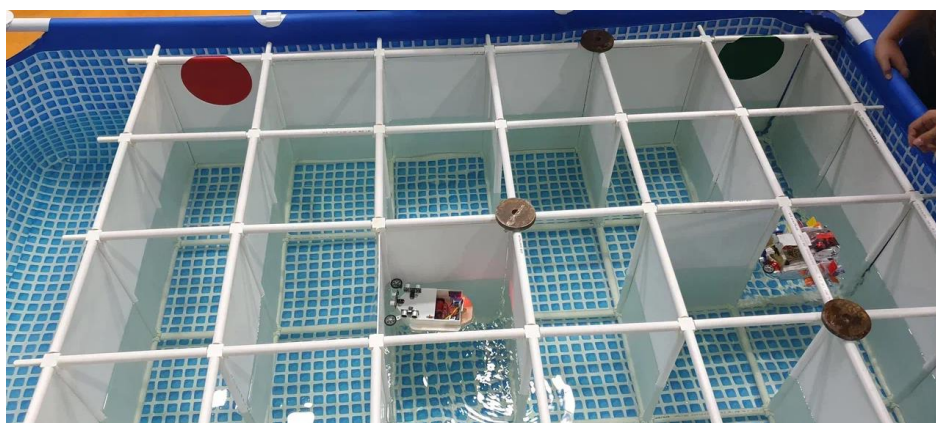
Рис. 1. Образец возможной конфигурации полигона. Ширина коридора лабиринта 30 см.
